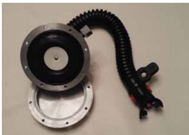
Si nota chiaramente la mancanza dello scarico nella scatola del secondo stadio
