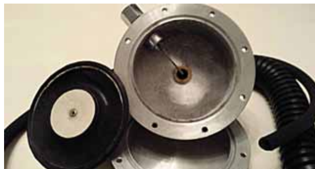
All'interno è visibile lo spillo del sistema up-stream e l'uscita centrale dell'aria convogliata nel corrugato
