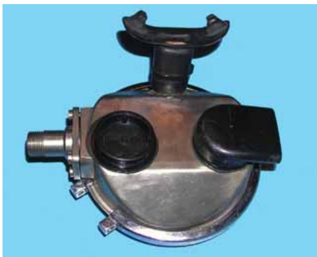
La parte posteriore con le due valvole di scarico
