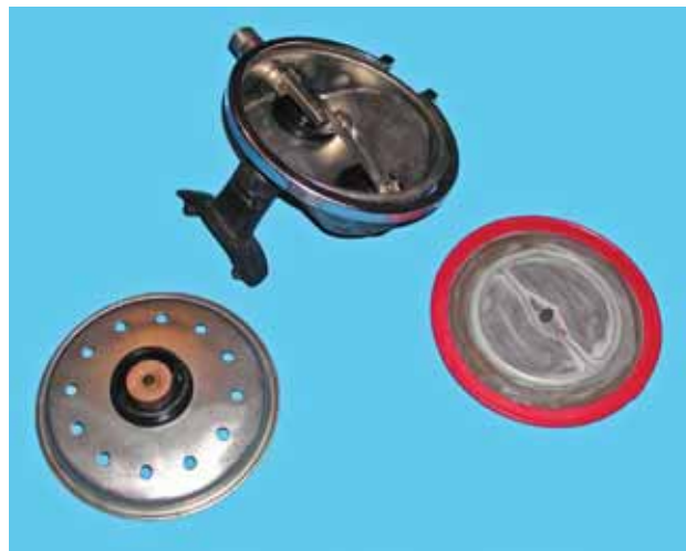
Il grande secondo stadio scomposto nelle sue componenti principali
